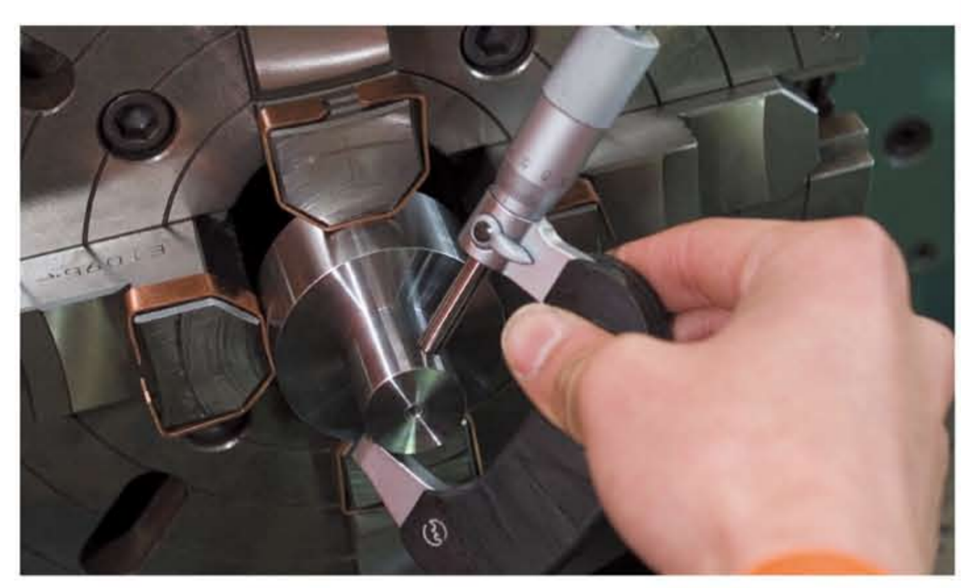
● マイクロメータでの測定では人体の体温で測定具が膨張することを防ぎます。
