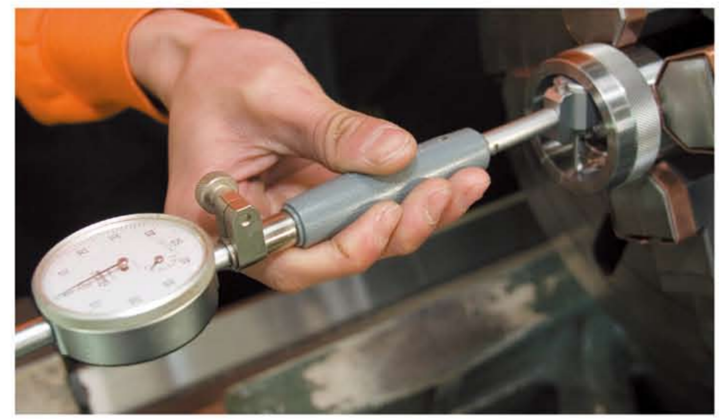
● シリンダゲージでの測定では内径を測る時に使います。
