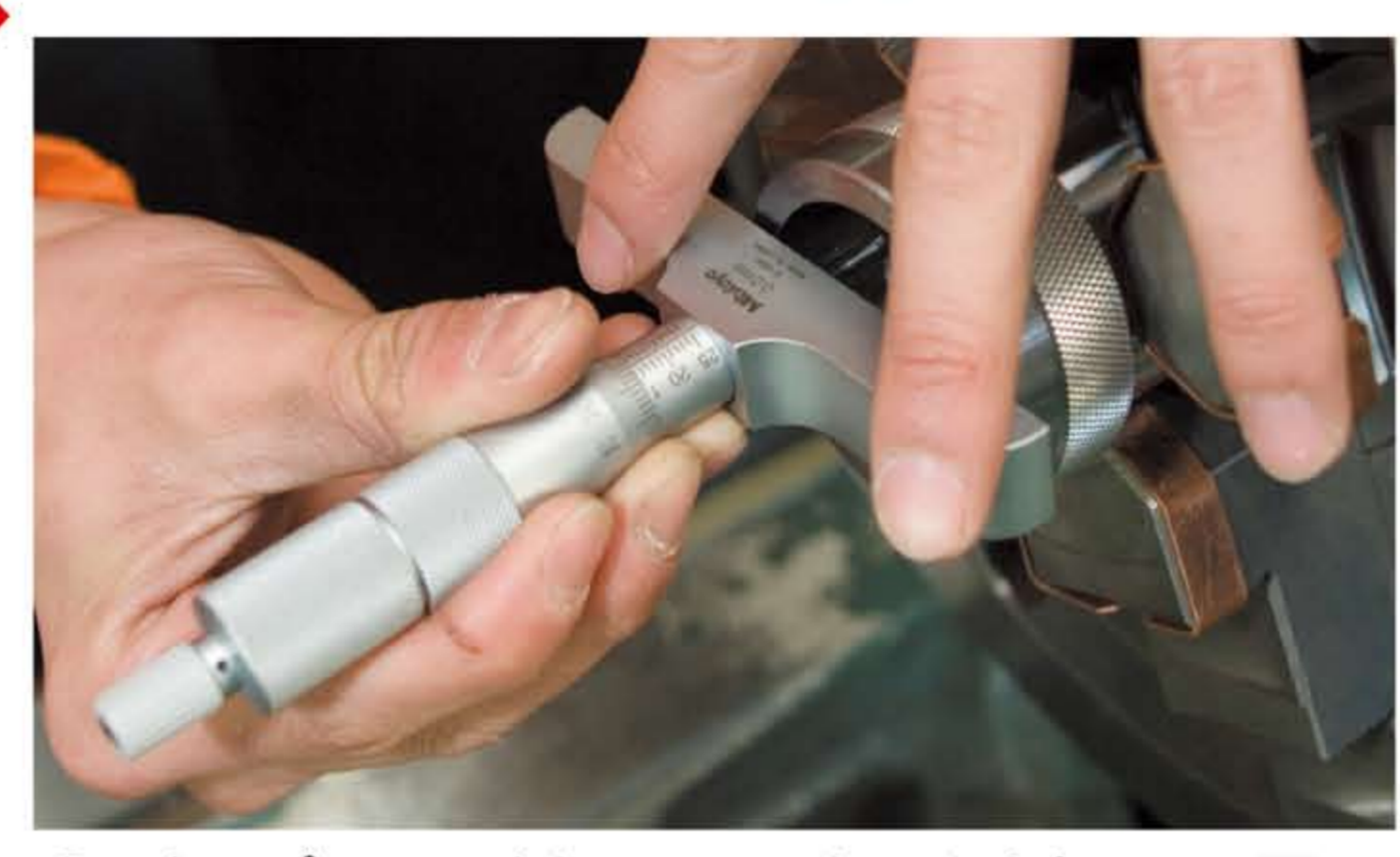
● デプスマイクロメータの測定では厚みを測る時に使います。
