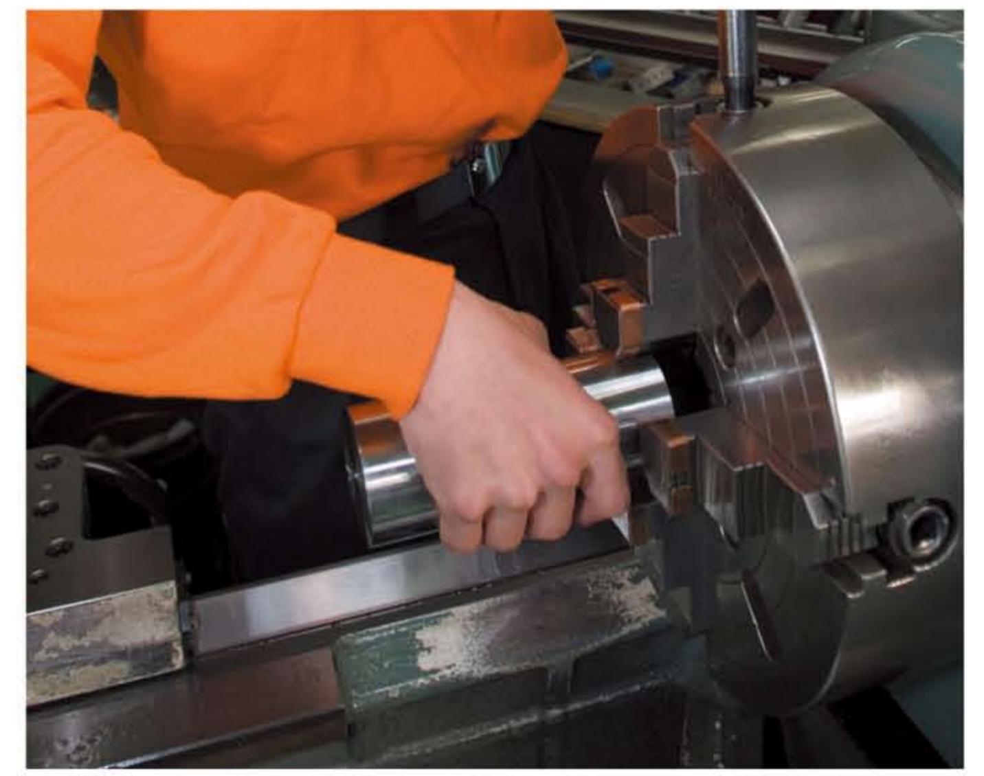
● チャックの爪に保護板を取り付け、材料を当てチャックを均等に締め付けます。
