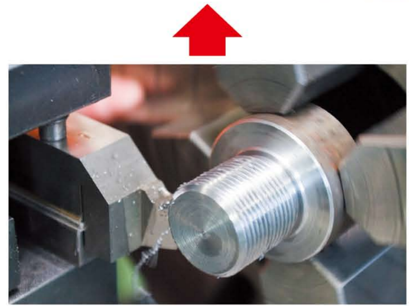
● 最終仕上げはねじのピッチは測定できないので外径削りや内径削りが異なり、カンとコツを最も要する加工です。ねじピッチに合わせ切り込み量を設定して、最後のはめ合わせは手で回して行います。
